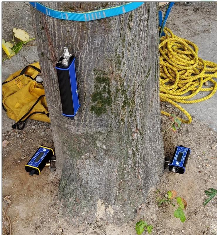
Figure 5 : Inclinomètres au niveau du sol et élastomètre placé pour ce test à 40cm de haut
