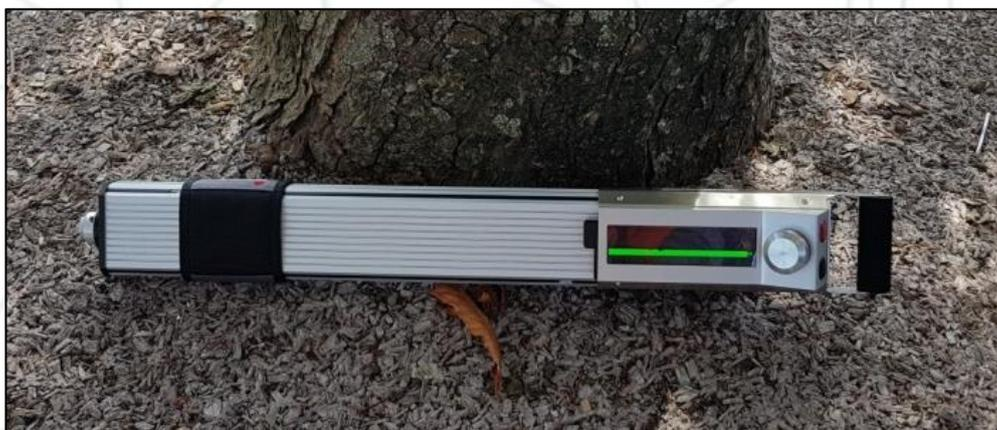
Figure 3 : Résistographe IML RESI PD400
