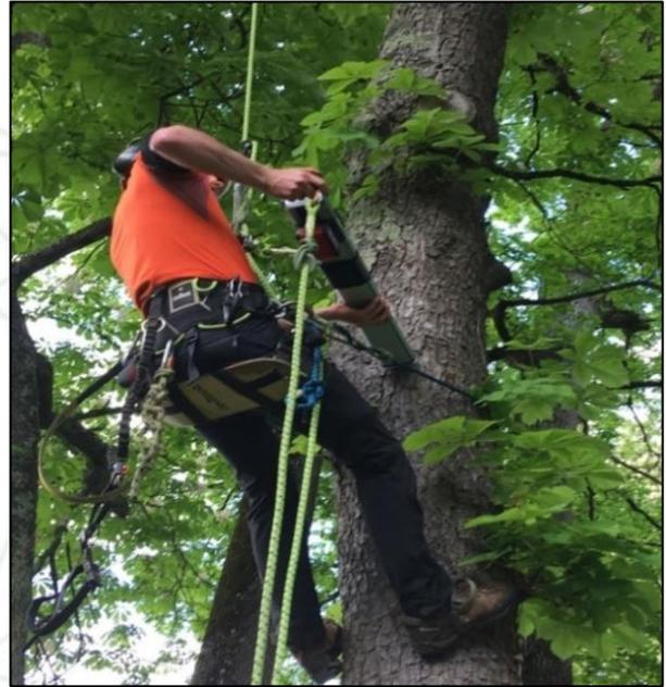
*Figure 7 : Sondage au résistographe d'un Marronnier (Aesculus hippocastanum) par un grimpeur*
